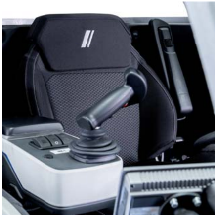
Joystick mit ergonomisch angeordneten Bedienelementen
